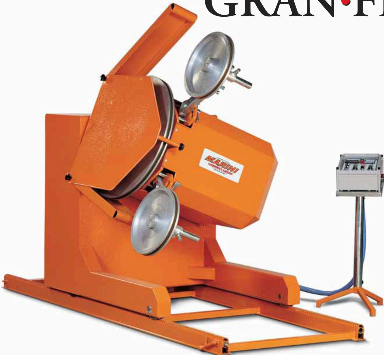
*Tagliatrice a filo diamantato* con motore da 50 HP a doppia velocità per tagli su granito. Un facile e rapido allineamento al taglio da eseguire è consentito dalla traslazione e rotazione di 360° del gruppo portavolano azionati da comandi manuali che permettono anche di eseguire due tagli paralleli ad una distanza di 1900 mm.
