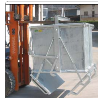
مخزن زیر باز شو حمل ضایعات با لیفتراک (ابعاد ۱.۱۵×۱.۶۲×۱.۶۲ متر، وزن ۳۸۰ کیلو گرم، ظرفیت ۲۰۰ لیتر یا ۳۵ تن)
